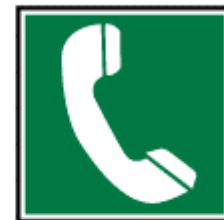
Téléphone pour le sauvetage et premiers secours
